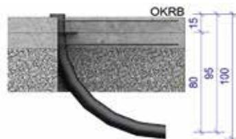
Unser 90° PE Hauskanalbogen ist die perfekte Durchführung für Ihren Gas- und Wasseranschluss oder Kabeleinführung. Erhältlich in den Größen DA 110 bis DA 160.
